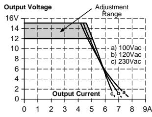
Fig. 5 / Bild 5 24V Output Characteristic / Ausgangskennlinie, typ.
